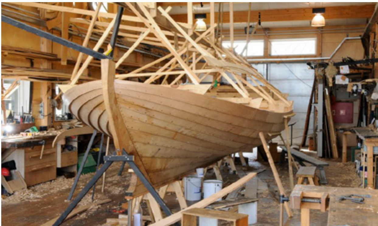
En klinkbygget båd er bygget af planker, som ligger udenpå hinanden – og sat sammen med jernnagler.
